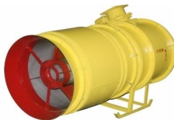
2.2-сурет – ВМЭ-6 желдеткіш қондырғысы
